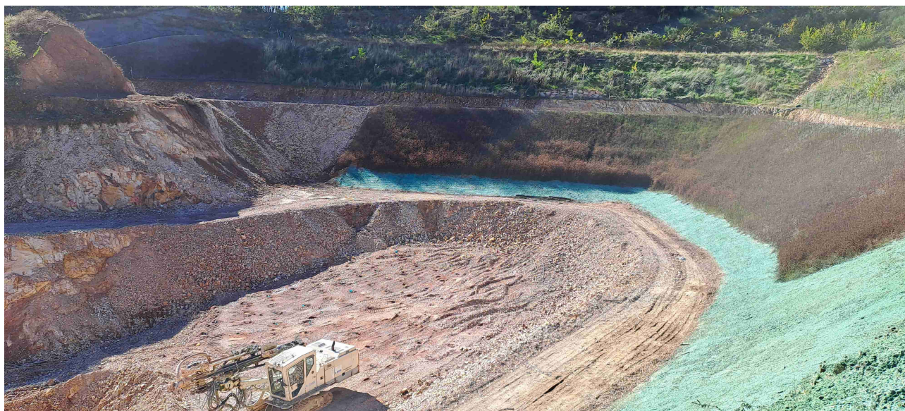
Figura 2: In primo piano, il cantiere con fori preparati per la volata, alle spalle i gradoni in recupero con idrosemina e quelli già recuperati
